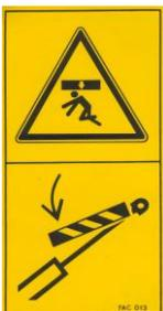
DANGER. LOCK THE LIFTING CYLINDER USING THE LOCKING DEVICE BEFORE STANDING UNDERNEATH THE LOADER
