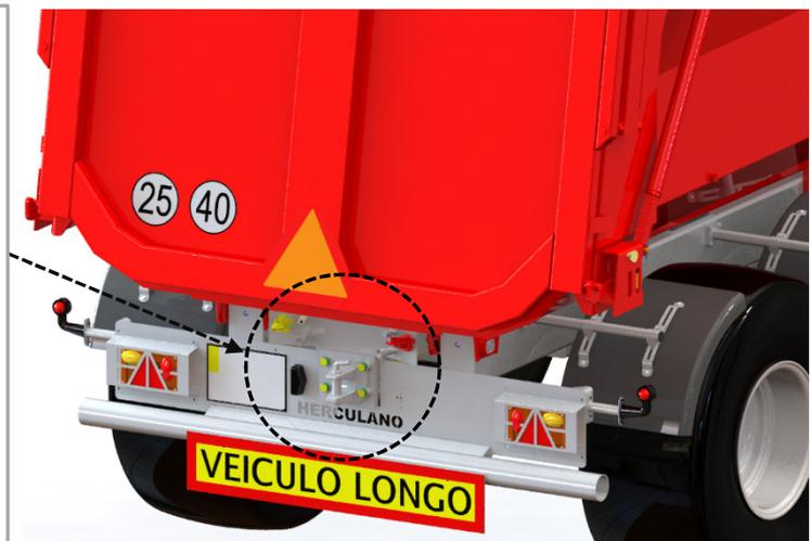
« Lorsque vous effectuez l'accouplement de la 2ème remorque, assurez-vous que tous les raccordements hydrauliques et/ou pneumatiques sont bien connectés et que les systèmes fonctionnent correctement. Testez toujours les systèmes avant de débiter la circulation, assurez-vous que le pivot d'attelage de l'anneau d'attelage est bien monté et avec la goupille de sécurité. »
