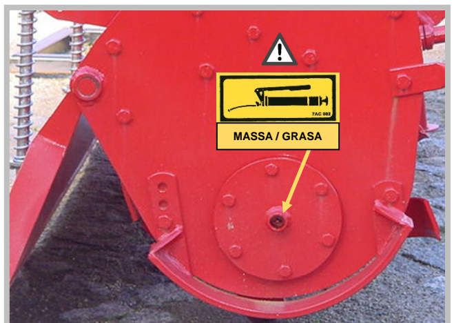
Lubrificação da chumaceira / Lubrificación del cojinete Modelos: STA ; STL ; STK ; STM
