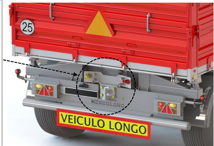
“Cuando realice el acoplamiento del 2º remolque, asegúrese de que todas las conexiones hidráulicas y/u neumáticas están bien conectadas y de que los sistemas funcionan correctamente. Compruebe siempre los sistemas antes de iniciar la circulación, asegúrese de que el pivote del enganche de anilla se encuentra bien montado y con el pasador de seguridad.”
