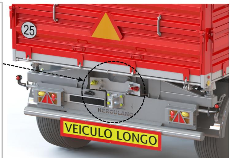
« Lorsque vous effectuez l'accouplement de la 2e remorque, assurez-vous que tous les raccordements hydrauliques et/ou pneumatiques sont bien connectés et que les systèmes fonctionnent correctement. Testez toujours les systèmes avant de débiter la circulation, assurez-vous que le pivot d'attelage de l'anneau d'attelage est bien monté et avec la goupille de sécurité. »
