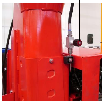
Posicionamento do regulador na máquina com extensão vertical de 0.20mt
