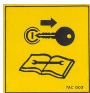
TURN OFF THE ENGINE BEFORE PERFORMING MAINTENANCE
