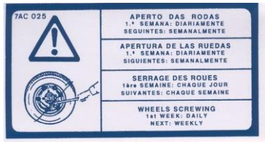
WHEELS SCREWING INDICATOR INDICATION DU SERRAGE DES ROUES
