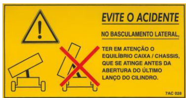
DANGER. KEEP THE BOX/CHASSIS BALANCE IN MIND. ENSURE THAT IT IS BALANCED BEFORE FULLY OPENING THE CYLINDER. DANGER. VEILLEZ À L'ÉQUILIBRE BENNE/CHÂSSIS QUI EST ATTEINT AVANT L'OUVERTURE DU DERNIER TRONÇON DU CYLINDRE.
