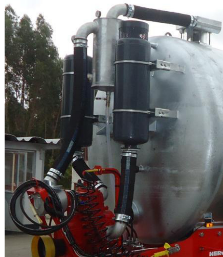
Lobe pump (DL) with silencers (≥ CH 14000) Pompe à lobes (DL) avec silencieux (≥ CH 14000)
