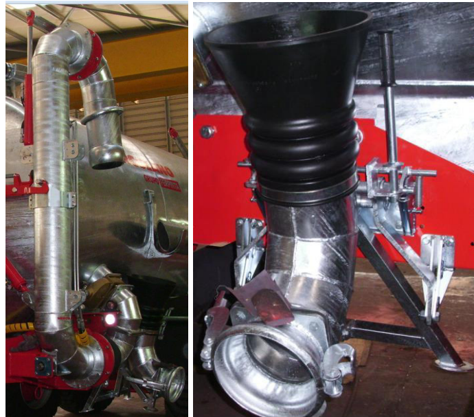
Lobe pump (DL) with silencers (≥ CH 14000) Pompe à lobes (DL) avec silencieux (≥ CH 14000)
