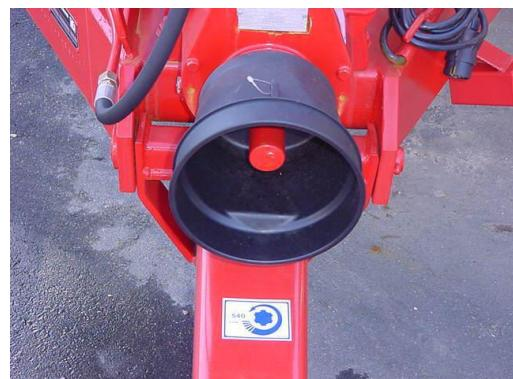
Retirar o descanso e colocá-lo no local próprio existente no chassis.
