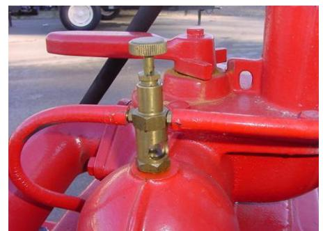
**Verificar el nivel de aceite de la caja de engranajes a través del visor (SAE 90).**
