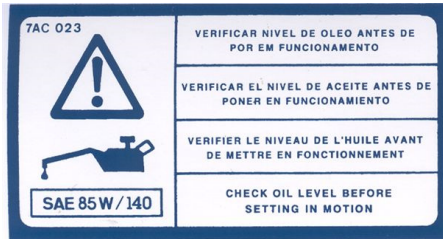
CHECK OIL LEVEL BEFORE SETTING IN MOTION. VÉRIFIER LE NIVEAU D'HUILE AVANT DE L'UTILISER.
